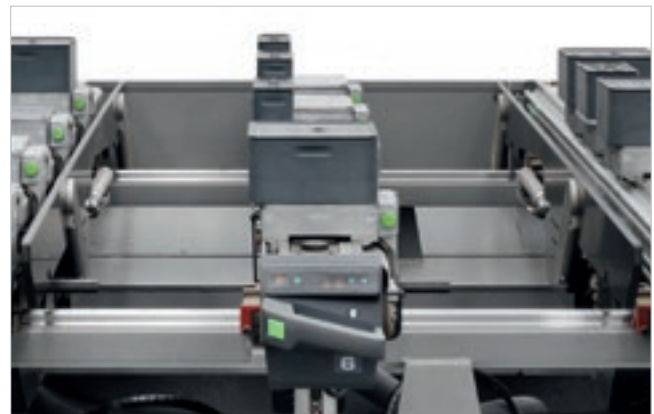
SA (设定辅助系统) 设定辅助工作台建议操作员如何定位板件 (指示工作台和吸盘的位置), 并且保护工作区域避免发生刀具碰撞。
